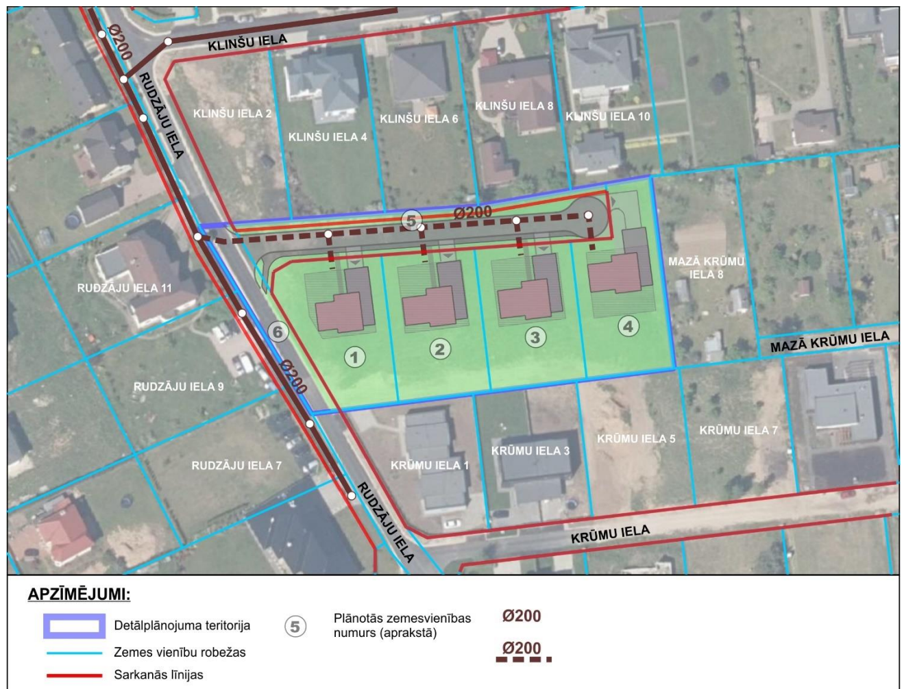
14.attēls. Plānotais sadzīves notekūdeņu kanalizācijas risinājums
